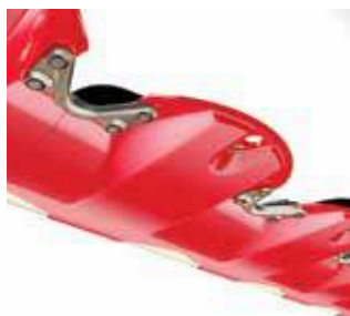
Proudnicový tvar žací lišty (v dolní části)
