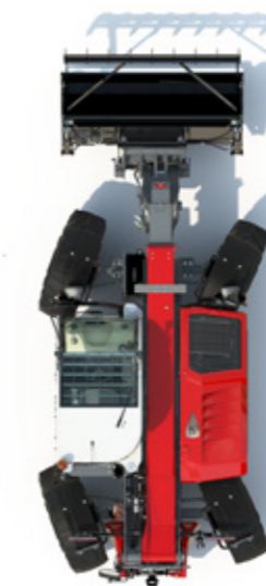
REŽIM ŘÍZENÍ čtyř kol – pro minimální průměr zatáčení.
