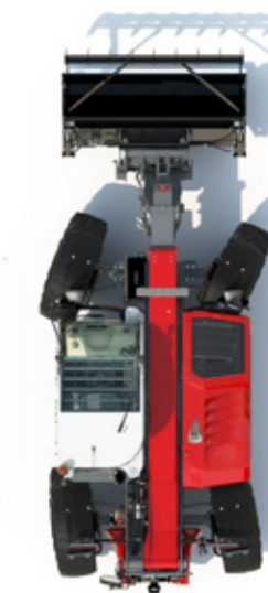
ČÁSTEČNÝ REŽIM kraba nastaví úhel zadních kol – vhodné pro práce například při silážování nebo čištění stodoly.
