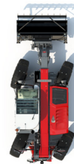
REŽIM řízení kraba – pro účelné plnění a nivelování a práci podél stěn ve stísněných prostorech.
