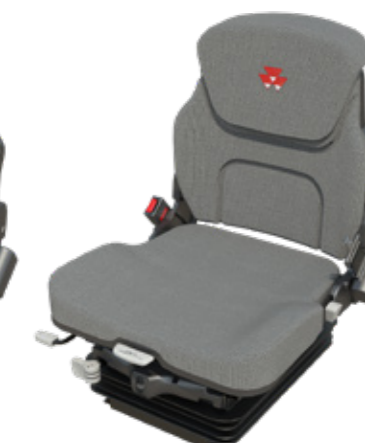
PNEUMATICKÉ ODPRUŽENÍ s podélným odpružením. K dispozici u všech modelů.*
