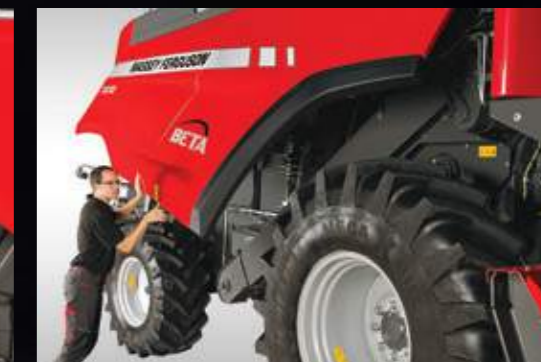
Jednodílné panely se světly umožňují rychlý přístup pro účely prohlídky
