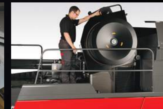
Bezpečný a snadný přístup pro čištění chladiče
